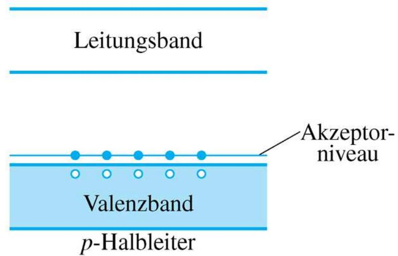
Ein *p*-Halbleiter, Gallium- oder Bordotiertes Silizium. (a) Gallium oder Bor besitzen nur drei Außenelektronen, so dass es einen leeren Platz oder ein *Loch* innerhalb der Struktur gibt. (b) Elektronen des Siliziumatoms können in das Loch springen und es ausfüllen. Effektiv bewegt sich das Loch an eine andere Stelle (in der Abbildung nach rechts), an der sich vorher das Elektron befunden hat.
